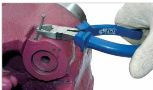
Для снятия насадки необходимо вытащить гвоздь
