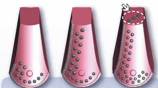
S – армирование спинки лапы твердосплавными зубками
