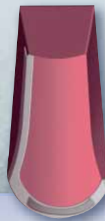
LL – наплавка набегающей грани и усиленная наплавка козырька
